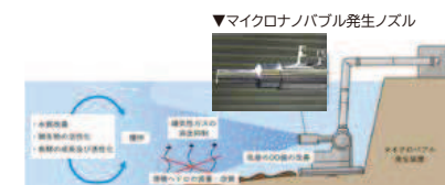
▲マイクロナノバブル曝気システムのイメージ図
